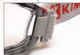
Ventilación indirecta con sistema AirFlow® para potenciar el antiempañante y visor panorámico en policarbonato.
